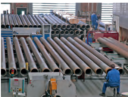
2011 Подсолевые залежи Бразилии: трубы BuBi® выложены перед первой обкаткой
